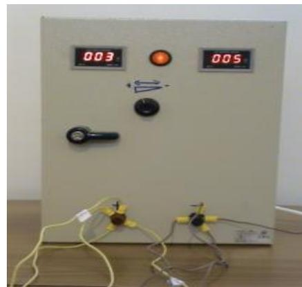
صورة (1) محوِّلة التيار الكهربائي المستخدمة
