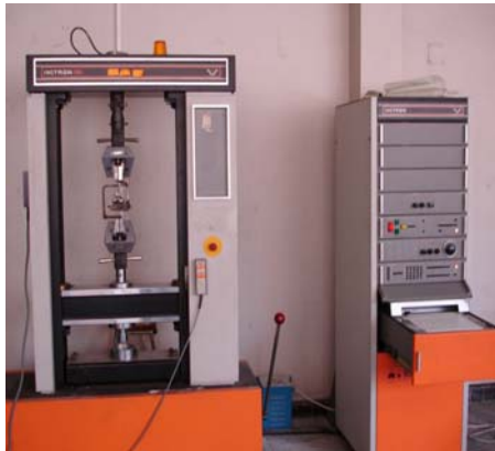
الشكل(2): جهاز الاختبارات الميكانيكية العام.
