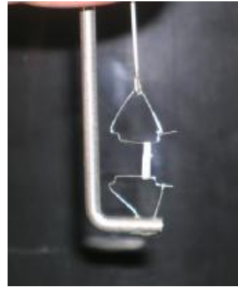
الشكل 4: الحلقة معلقة بين خطافين بداخل الحمام المائي.
