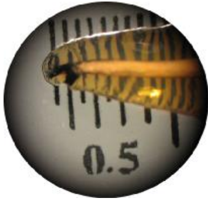
الصورة رقم 3: طريقة قياس تسرب بالمسطرة الشفاف تحت
