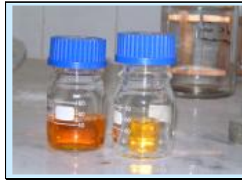
الشكل (2) : يظهر في الصورة زجاجة Schott العادية وإلى جانبها الخلية المعدلة وبداخلها الأنبوب الزجاجي وإلى جانبها يظهر اختلاف الألوان باختلاف تركيز الكحول .
