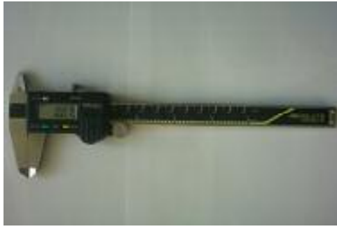
شكل (1) أداة قياس رقمية من شركة Mitutoyo اليابانية Model NoCD-6"CS بدقة 0.01
