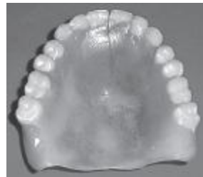
الشكل (1) الكسر المتوسط الناجم عن التعب في جهاز كامل علوي مفرد (Chowdhury LCSR و Dhiman CRK) (10) .
