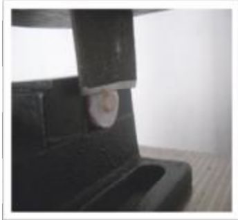
شكل (6) العينة في أثناء إجراء قوى القص، باستخدام جهاز الاختبارات الميكانيكية العام
