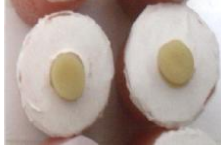
شكل (5) أقراص الكمبيوتر مرتبطة بسطح الزيركون وجاهزة لإجراء اختبار قوى القص
