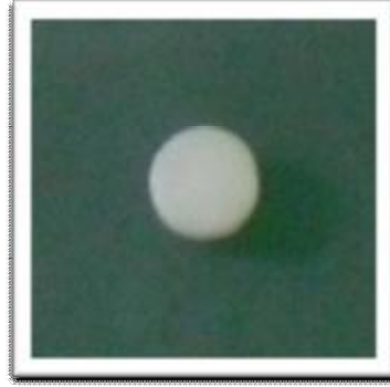
شكل (1) قرص الزيركون قبل وضعه ضمن القالب الاكريلي
