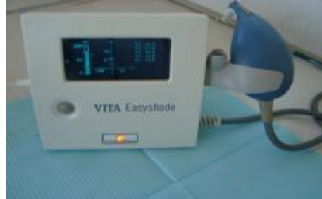
شكل رقم (2): جهاز كاشف اللون إلكتروني Vita Easyshade لشركة Vita Zahnfabrik المستخدم في البحث.
