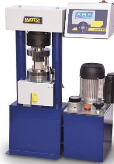
الشكل (8) : جهاز اختبار مقاومة الضغط لمكعبات المونة
