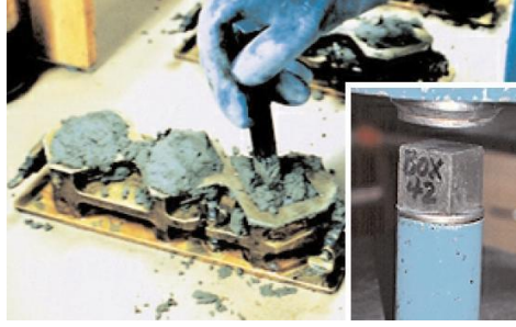
الشكل (7) : تعبئة القوالب المكعبية
