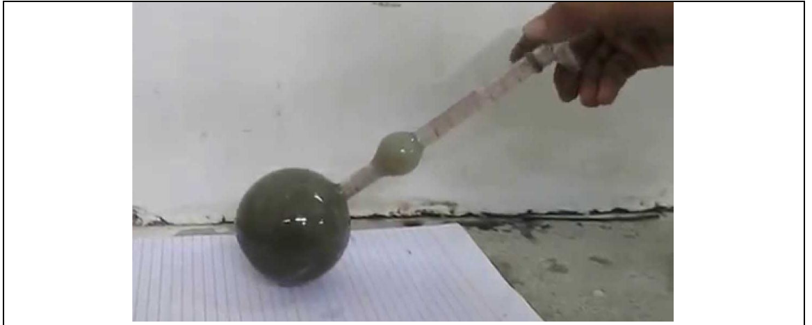
الشكل (2): تحريك قارورة لوشاتوليه وهي بوضع مائل
