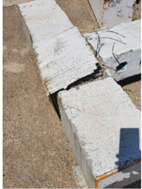
(الشكل رقم 9): تضعيف الجوائز وتقوية العمود بغرض تحقيق الفيوز الإنشائي
