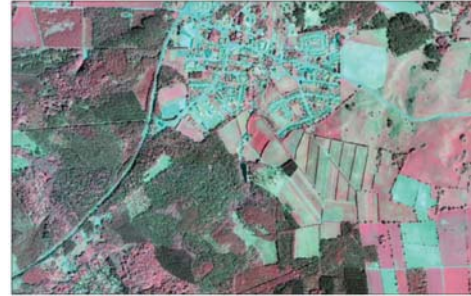
الشكل رقم (14 e): صورة جويّة رقمية ملوّنة بالأشعّة تحت الحمراء عام 2010، ارتفاع طيران 4600 متر، دقّة الأرض 0.25 متر تقريباً
