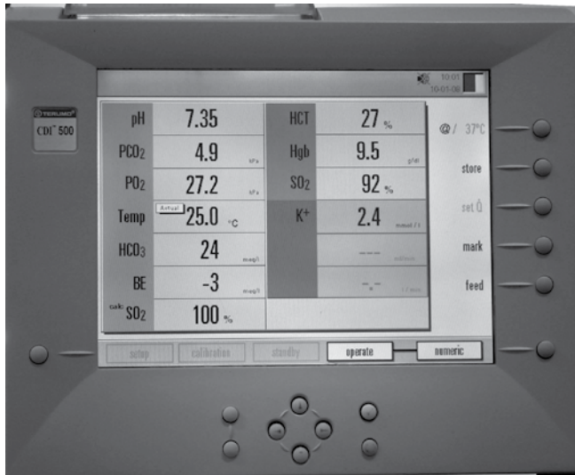
الشكل 14 - جهاز Terumo CDI500 للمراقبة ضمن الخط، وهو يوفر تحليلاً آتياً لغازات الدم والتوازن الحمضي/القاعدي، والخضاب/الهيماتوكريت، والشوارد.
