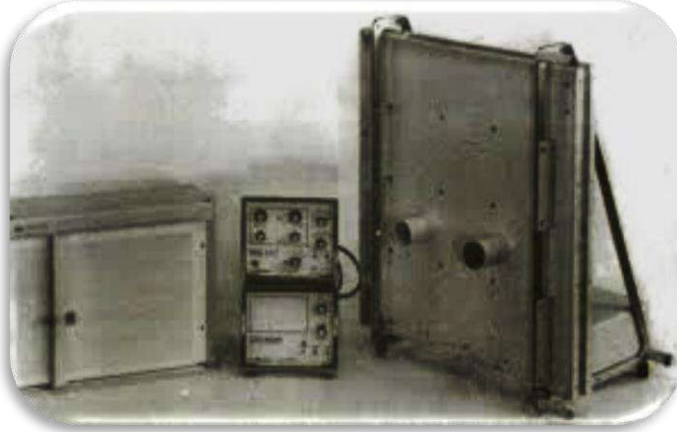
الشكل رقم (4-8) السبيروميتر الإسفنجي Wedge Spirometer
