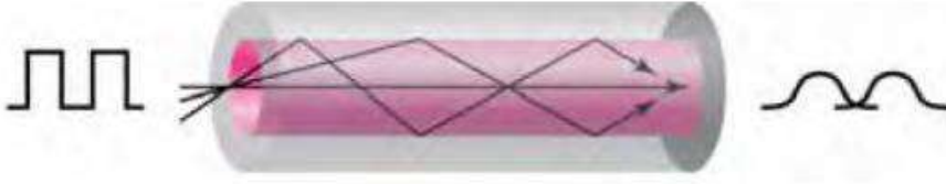
الشكل (7-8) مسار الشعاع في الليف البصري ذو النمط المتعدد ومعامل الانكسار الخطوي
